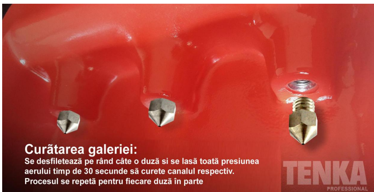
Figura 7. Curățarea canalelor galeriei pneumatice
